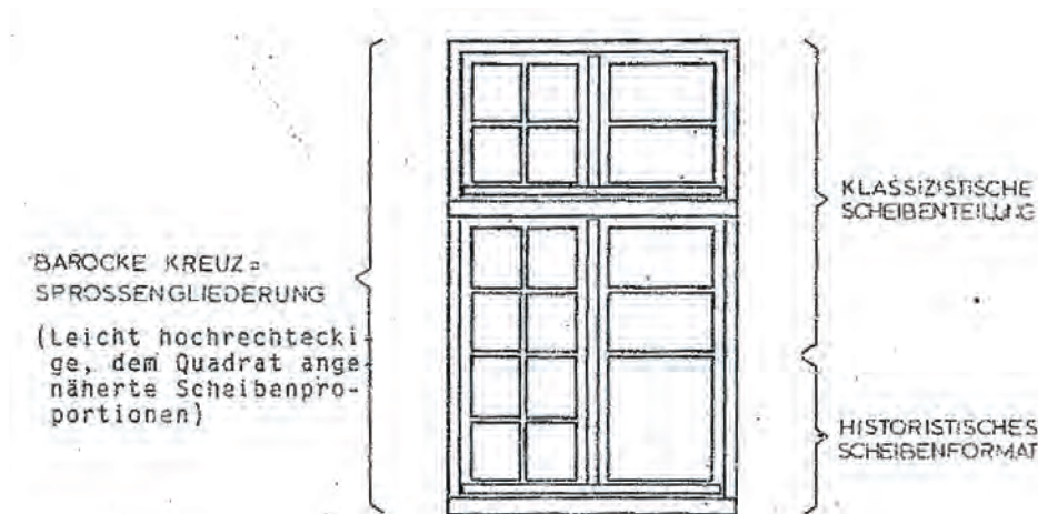
Entwicklung der historischen Holzsprossen-Fensterteilungen am Beispiel eines Fensters mit Kämpfer und Oberlicht (vereinfachte schematische Darstellung)
