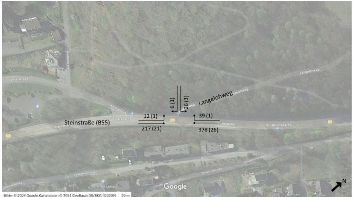
Abbildung 22: Prognostizierte Verkehrsbelastung in Stufe 2 zur späten Spitzenstunde am Knoten 2 [Kartengrundlage: Google Maps] (Legende 5 (1): 5 Pkw-Fahrten (1 Lkw-Fahrt))
