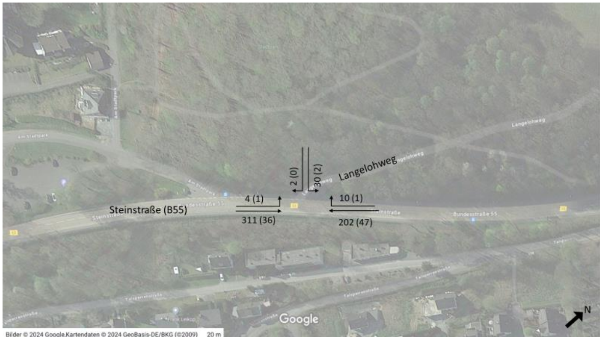
Abbildung 11: Prognostizierte Verkehrsbelastungen in Stufe 1 am Knoten 2 zur frühen Spitzenstunde [Kartengrundlage: Google Maps] (Legende 5 (1): 5 Pkw-Fahrten (1 Lkw-Fahrt))
