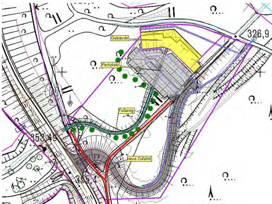
Abb. 2 Lage des geplanten Gebäudes, des Parkplatzes, des Fußweges und der Zufahrt auf Grundlage der DGK 1:5.000 (KOTTHOFF 2016). Der zum Rückbau vorgesehene Bereich ist rot dargestellt (skizziert).
