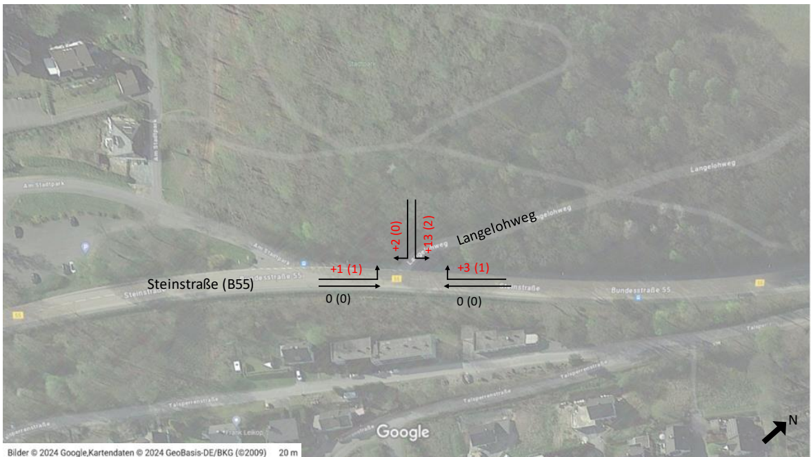
Abbildung 15: Veränderung der frühen Verkehrsströme in Stufe 1 am Knoten 2 zur Analysesituation [Kartengrundlage: Google Maps] (Legende 5 (1): 5 Pkw-Fahrten (1 Lkw-Fahrt))
